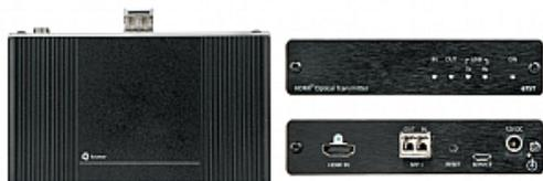
675R/T es un kit extensor de fibra HDMI de alto rendimiento para la extensión de ultra alcance de señales HDMI 4K@60Hz (4:4:4). 675T convierte la señal de entrada HDMI en una señal óptica que se transmite a través de un cable de fibra óptica al 675R, que la convierte de nuevo en una señal HDMI. El 675R/T incluye 2 transceptores SFP + multimodo, pero se puede utilizar con cualquier transceptor SFP + certificado por Kramer, como un transceptor SFP + monomodo
